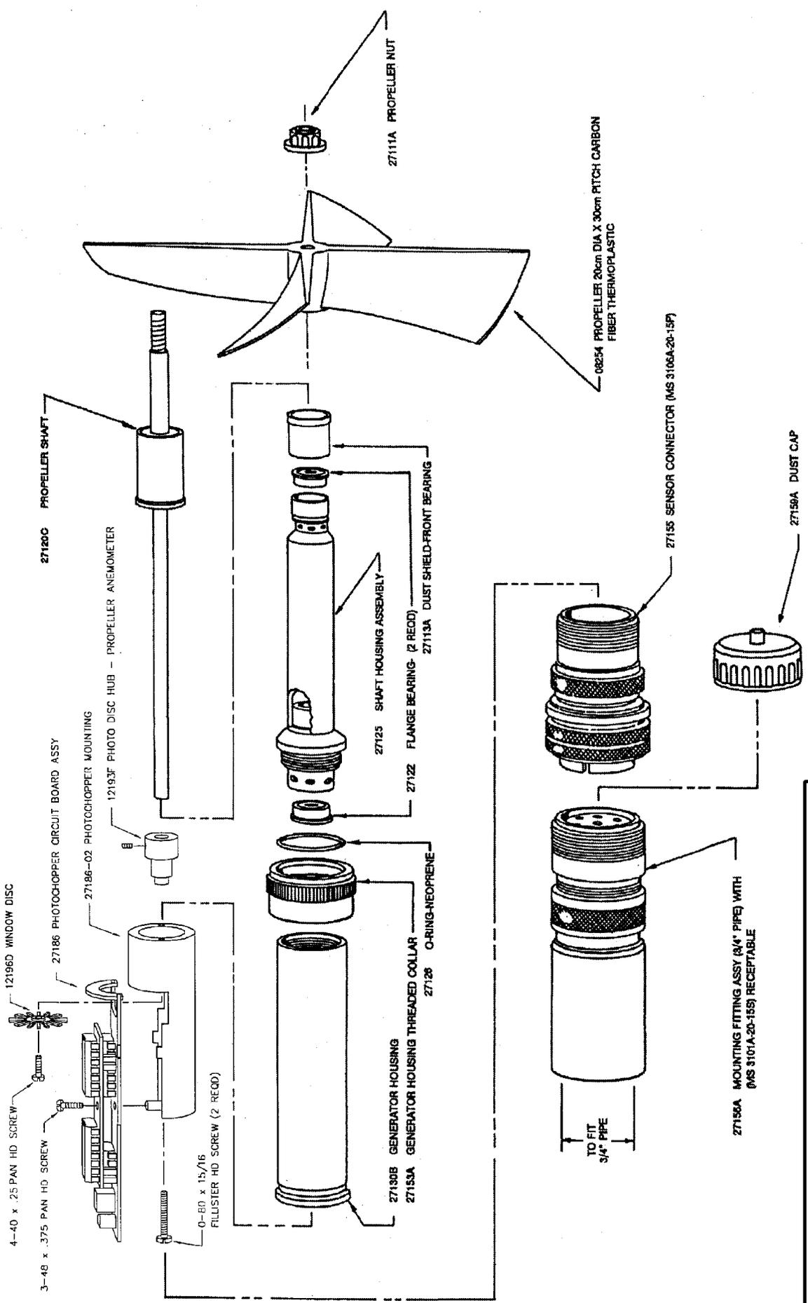
**GILL PROPELLER ANEMOMETER**
